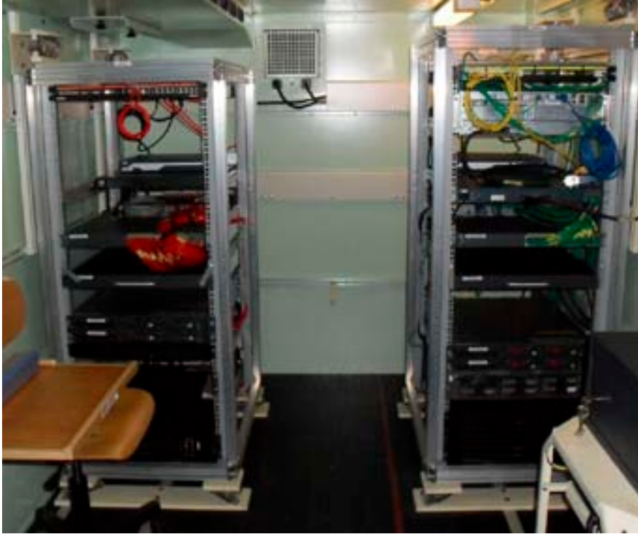
Fig. 2: de ontplooibare netwerken met hun servers, geïntegreerd in een shelter.
