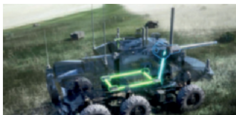
Alle sensoren zijn via de vetronica en de radio's in real time met elkaar verbonden
