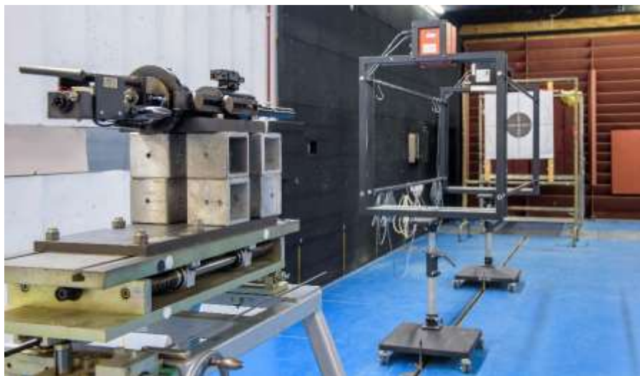
Laboratoire de balistique : tube avec capteurs de pression et base de mesure de vitesse
